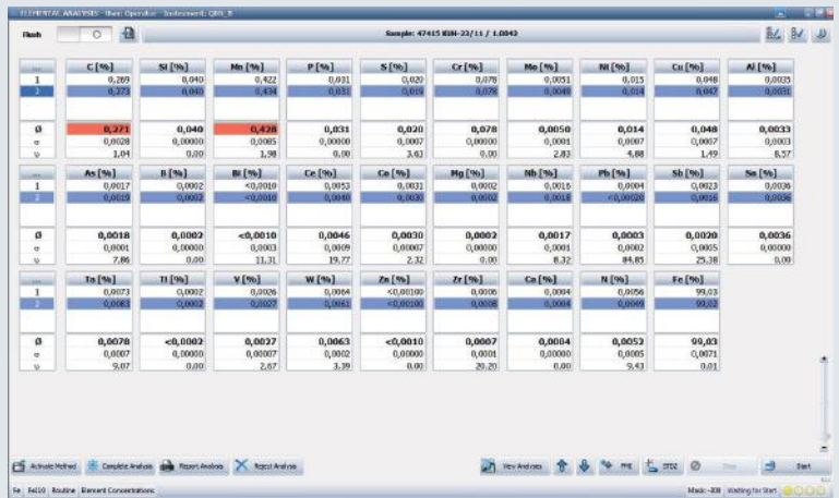
Fig. 2: Spektrometersoftware: Von der Durchführung von Messungen bis zur automatischen Mittelwertbildung, farbige Qualitätsüberwachungsanzeige, E-Mail-Versand, das Einrichten von TRS und Anzeige der Einzel-funktenverteilung: die Definition von individuellen Benutzer-Ebenen gibt jedem, was er braucht.
